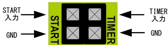
端子間をショートソケット、スイッチ、フォトカプラー、リレーなどでショート／オープンすることにより、温度制御動作の開始／停止、タイマー動作の開始／停止を操作できます。
