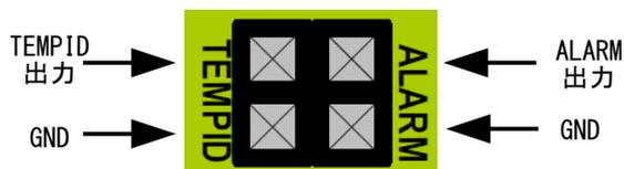
オープンコレクタ出力で、インジケータおよびアラームの発生状況により以下のように出力されます。
