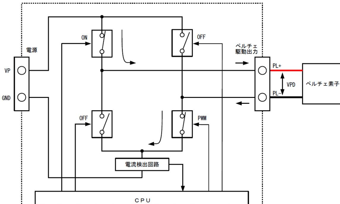
この図では、冷却方向に駆動している時の状態を示しています。
