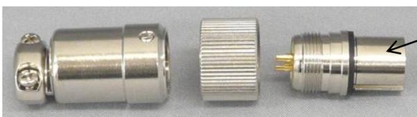
左端のピースを持ちながら、右端のこの部分を反時計方向に回すと写真のように3つのピースに分かれます。(固くて回りにくい場合は、イモネジを緩めた状態でDWA-30の電源コネクタ部分に挿して、左端部分を反時計方向に回すと簡単に緩みます。)
